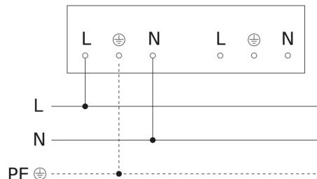
Diagrama electrónico interconexión maestro-esclavo y maestro-maestro
